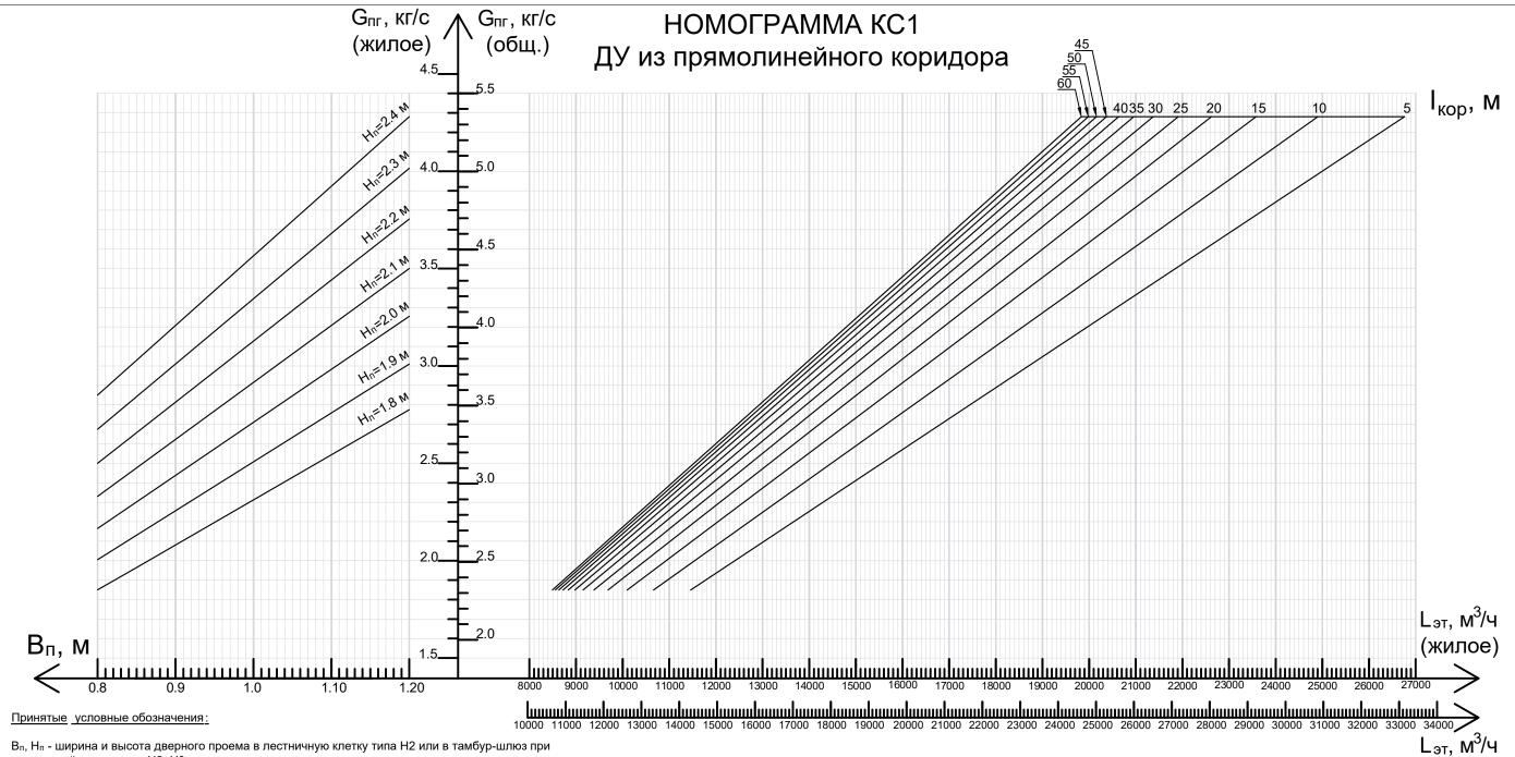
$B_n$ ,  $H_n$  - ширина и высота дверного проема в лестничную клетку типа H2 или в тамбур-шлюз при лестничной клетке типа Н2+Н3 м;
